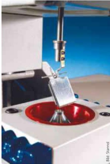
Per Mikro-Benetzungswaagentest lassen sich mithilfe der „Step Et Repeat“-Funktion mehrere Miniatur-Kontakte in Serie testen
