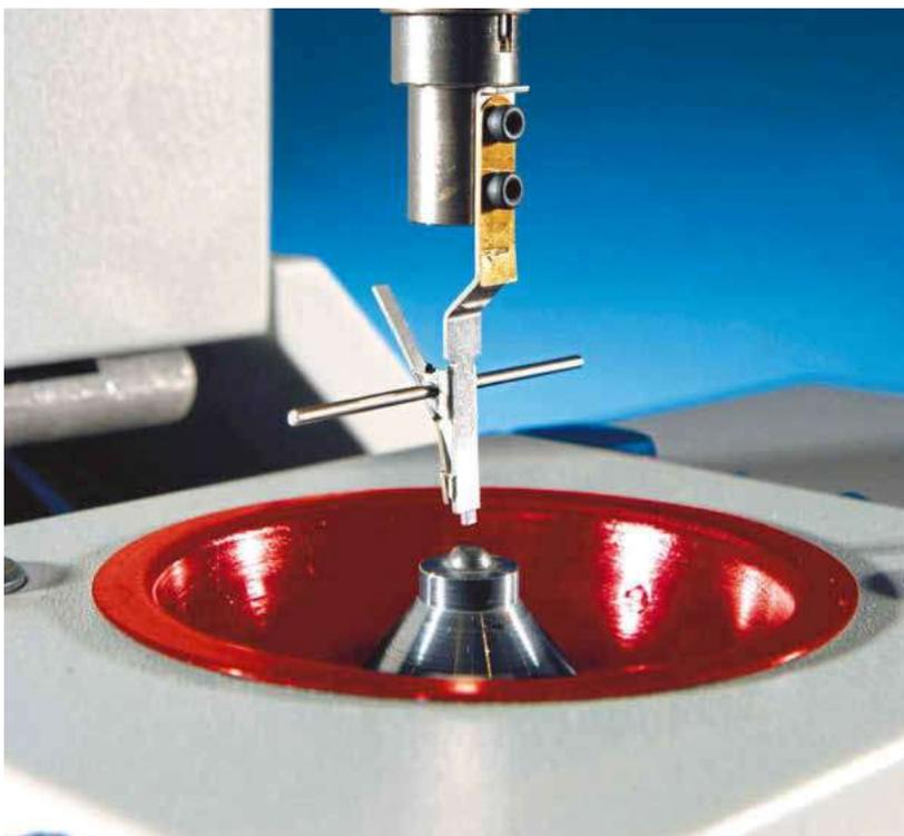
Beim Mikro-Benetzungswaagentest wird das Lotbad durch einen Block mit Lotkugel ersetzt
