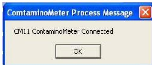
Hinweis: Wenn eine Fehlermeldung angezeigt wird, dass das CM nicht angeschlossen wurde, klicken Sie auf OK und überprüfen Sie die Verbindungen des USB. Schalten Sie das CM22 aus und wieder ein und klicken Sie nochmals auf die Schaltfläche „Connect“.
