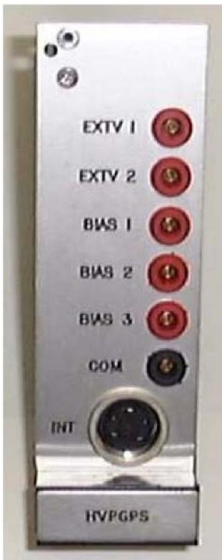
EXTV 1: zum Anschluss einer externen Bias-Spannung, nur eingesetzt als Ruhespannung, wenn eine andere Bias-Spannung an die Probe angelegt werden muss
