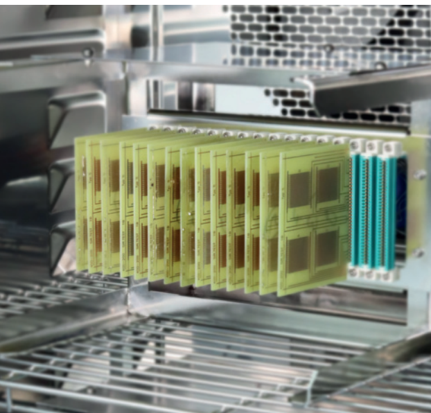
Präparierte Testboards im Klimaschrank. Klima: Temperatur 40 \pm 1 \text{ }^\circ\text{C} / Relative Luftfeuchte 90 \pm 3 \% über 168 Stunden
